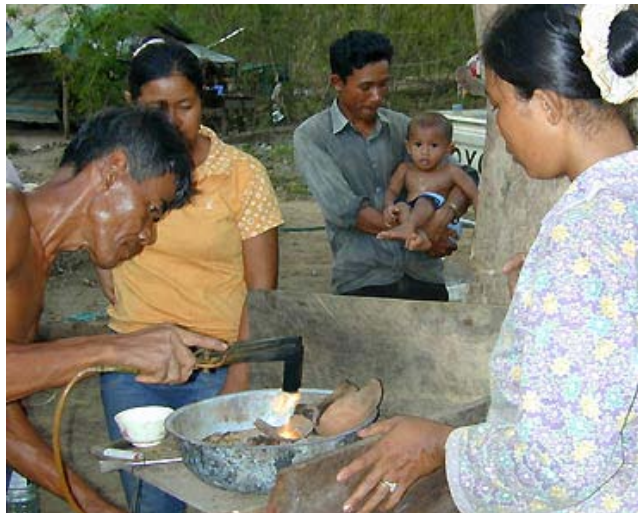
Goldgewinnung mittels Quecksilber in den Entwicklungsländern
