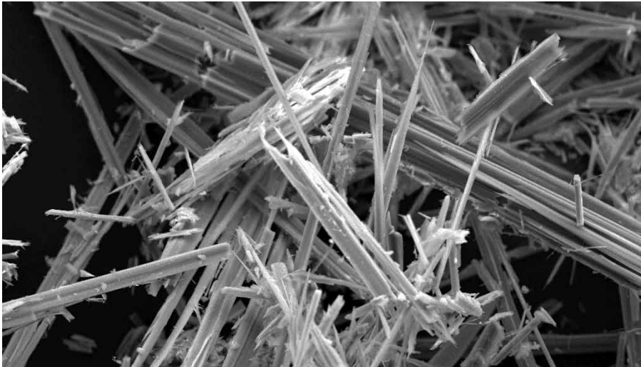
Lungengängige Asbestfasern (Amphibol, REM-Aufnahme)
