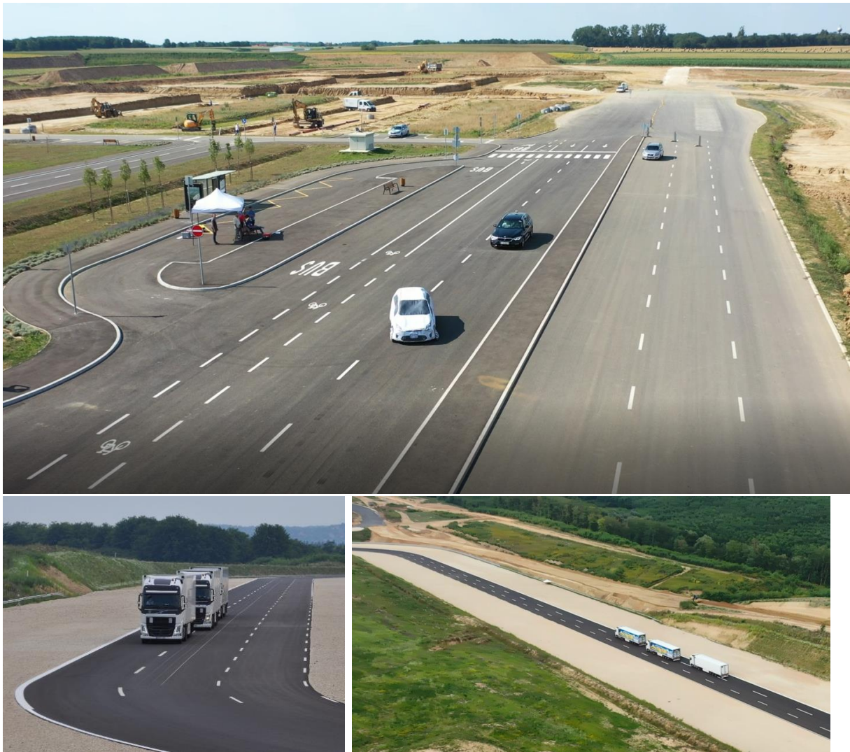
Abbildung 24: Durchführung von Platooningtest auf den High Speed Handling Kurs in ZalaZone (Juli/September 2019)
