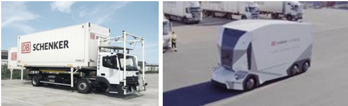
Abbildung 2: links: bemannte Variante der Firma KAMAG, rechts: unbemannte Variante Firma Einride (T-POD)
