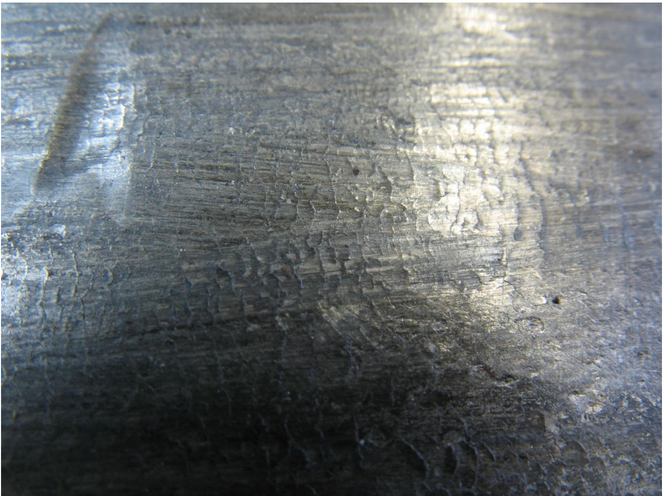
Abbildung 17 Riss-Netzwerk Lauffläche (Quelle Abbildung 3 im Gutachten [2])
