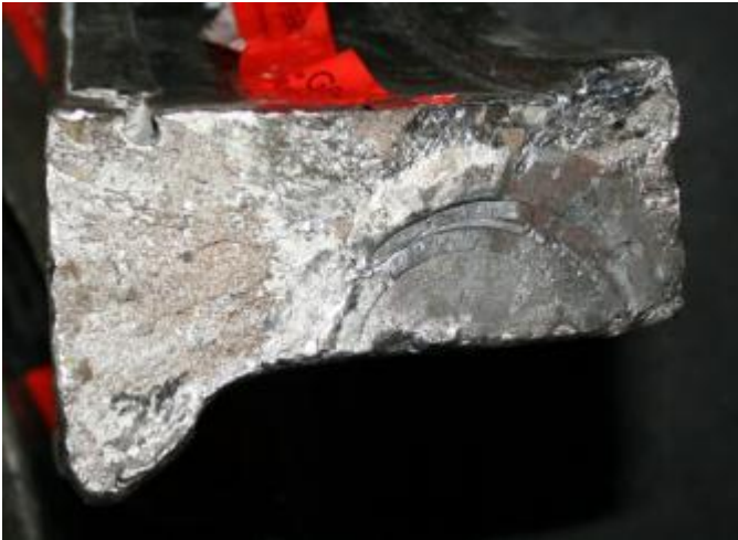
Abbildung 16 Bruchstelle Bruchteil 2 (Quelle SUB)
