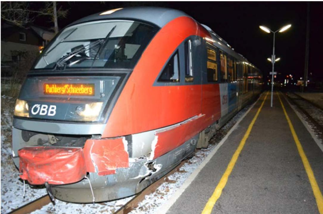
Abbildung 13 Ansicht der beschädigten Frontpartie des Tzg - Quelle [www.einsatzdoku.at](http://www.einsatzdoku.at)
