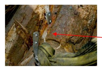
Abgerissener Griff des windenseitigen Greifzuges mit Rundschlinge, verkeilt in gelagerten Baumstämmen
