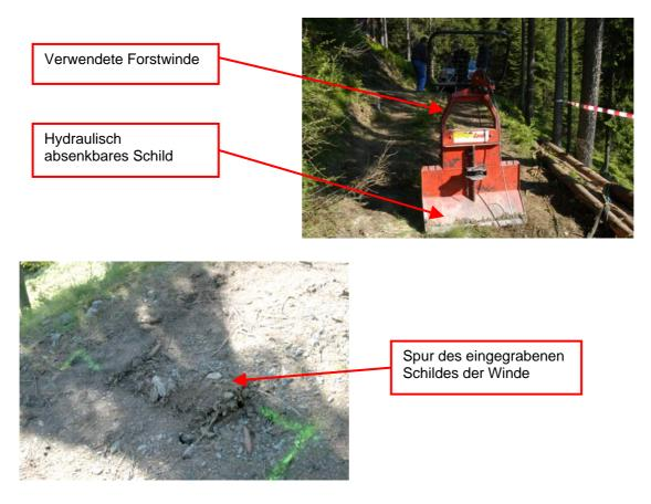
Die verwendeten Arbeitsmittel wurden vor Arbeitsbeginn einer Funktionsprobe unterzogen. Um das Förderseil abspannen zu können, war es aufgrund der Übersetzung des 12-rolligen Flaschenzuges und der kurzen Wegstrecke zwischen der Umlenkrolle und der Forstwinde nötig, den Zugvorgang mehrmals zu unterbrechen, um den am Scherseil montierten Greifzug nachzusetzen.
