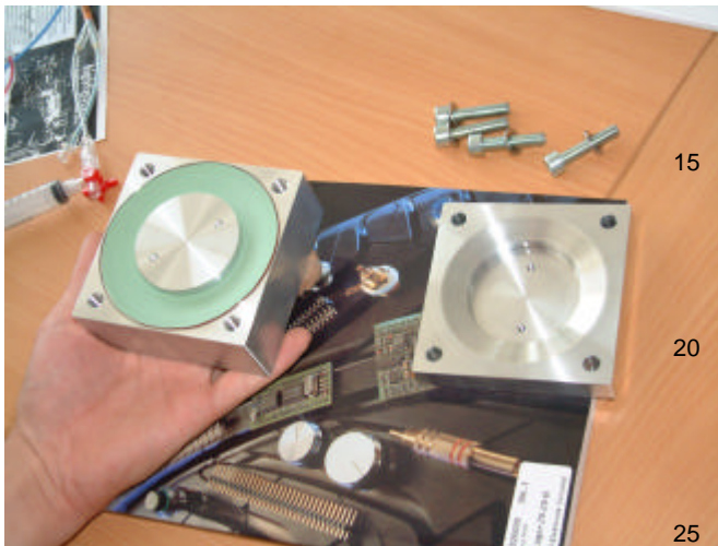
Bild 3: Membrangehäuse und Membran der Pumpe
