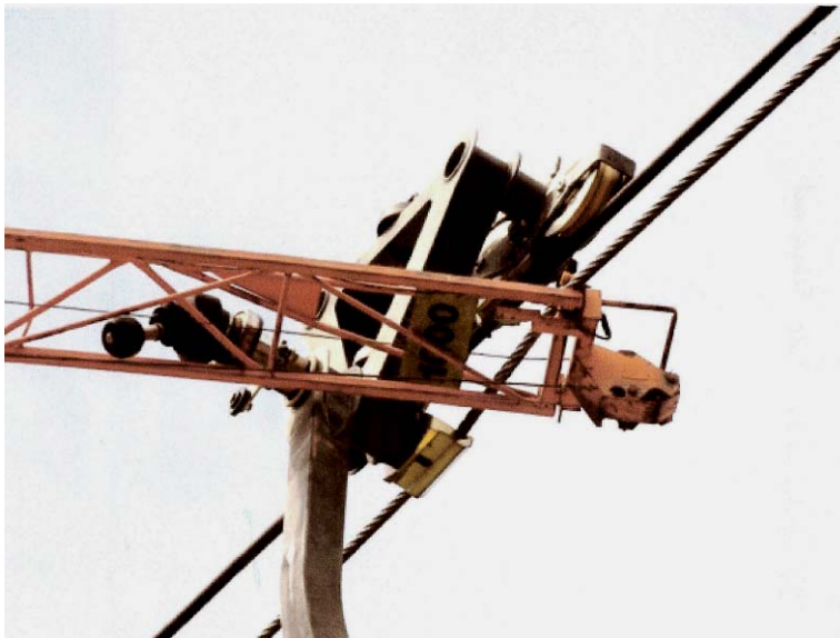
Abbildung 3 Kranausleger im Zugseil
