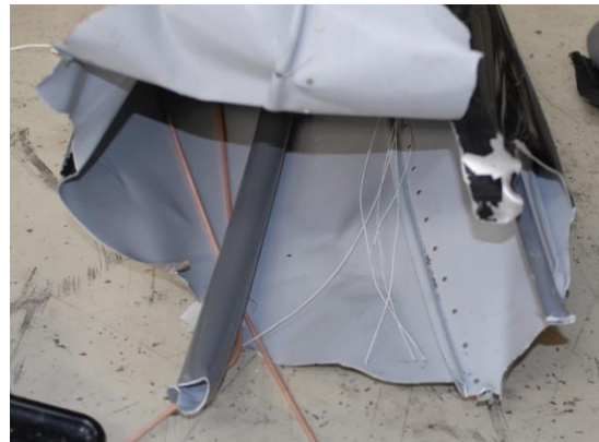
Abb. 10: Bruchstelle Heckrotorantriebswelle & Heck rotor Steuerstange(Quelle: SUB)
