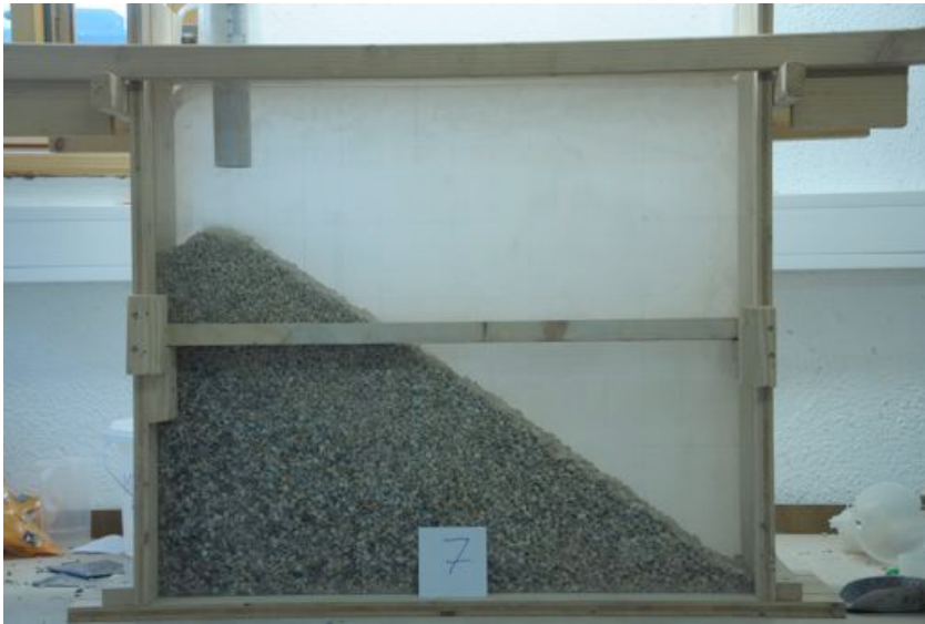
Bild 1: Versuchsaufbau zur Bestimmung des Schüttwinkels im Spalt
