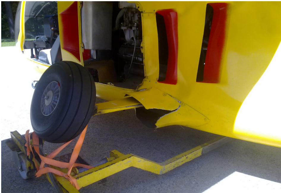
Abbildung 2 Beschädigung des linken Hauptfahrwerks
