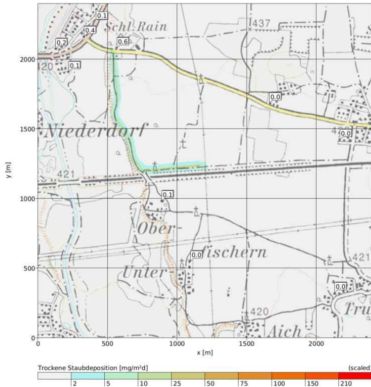
Abbildung 60: Baubedingte trockene Staubdeposition [mg/m 2 .d] im Abschnitt 7 Grafenstein.
