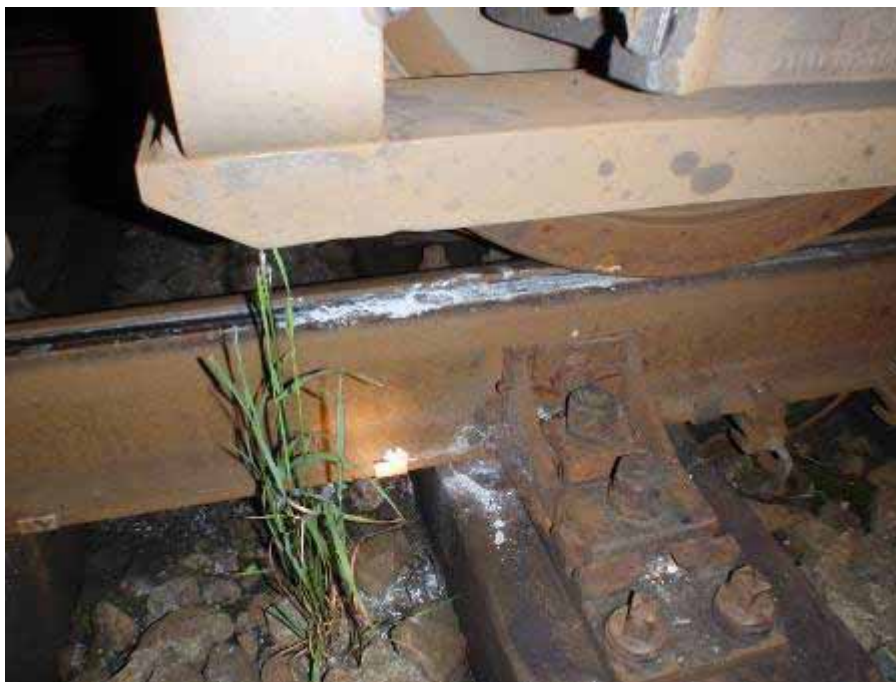
Abb. 10 Zermalmte Steine am rechten Schienenstrang der Weiche 2
