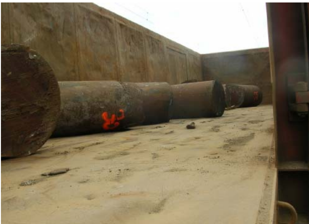
Verrollte Ladung (Ansicht gegen die Fahrtrichtung)
