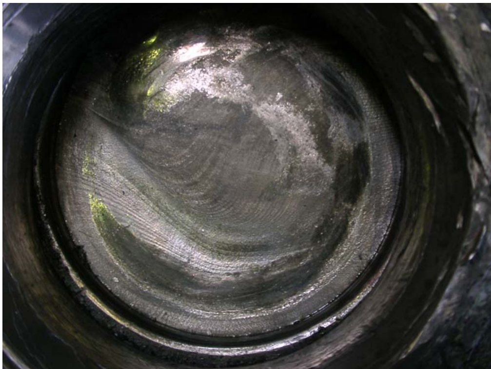
Detail der Bruchstelle innerhalb des Radsatzlagers
