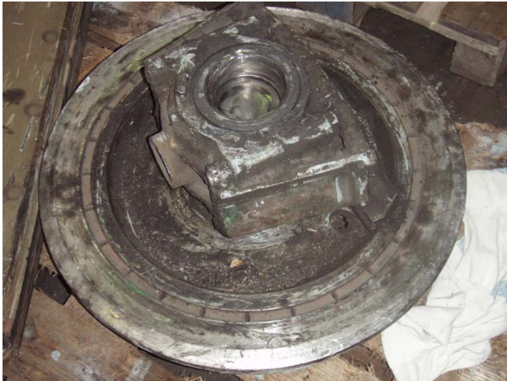
Radscheibe mit innenliegendem Radsatzlagergehäuse
