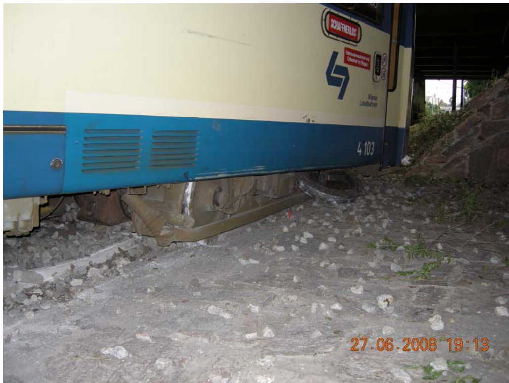
TW 103 mit entgleistem Drehgestell (Systemzeit = MEZ)
