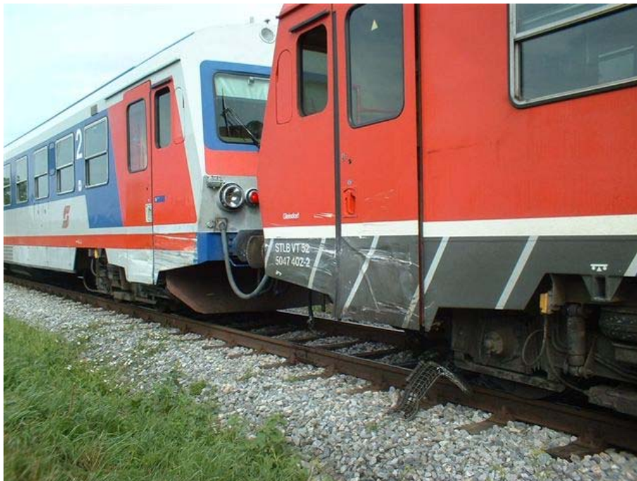
Aufprallstelle am nachgereichten VT 5047 402-2 ← Fahrtrichtung Z 7822 Richtung Neusiedl am See
