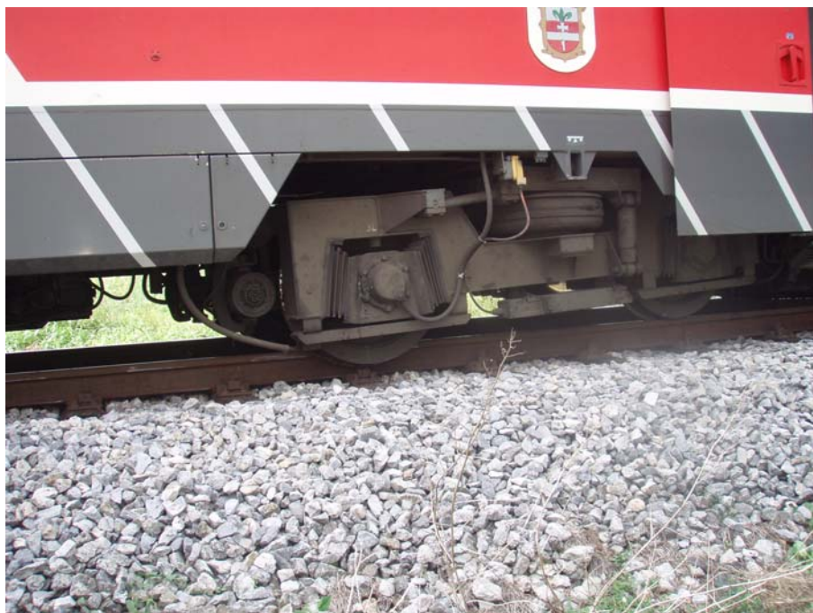
Entgleister Radsatz am nachgereihten VT 5047 402-2 Fahrtrichtung Z 7822 Richtung Neusiedl am See →
