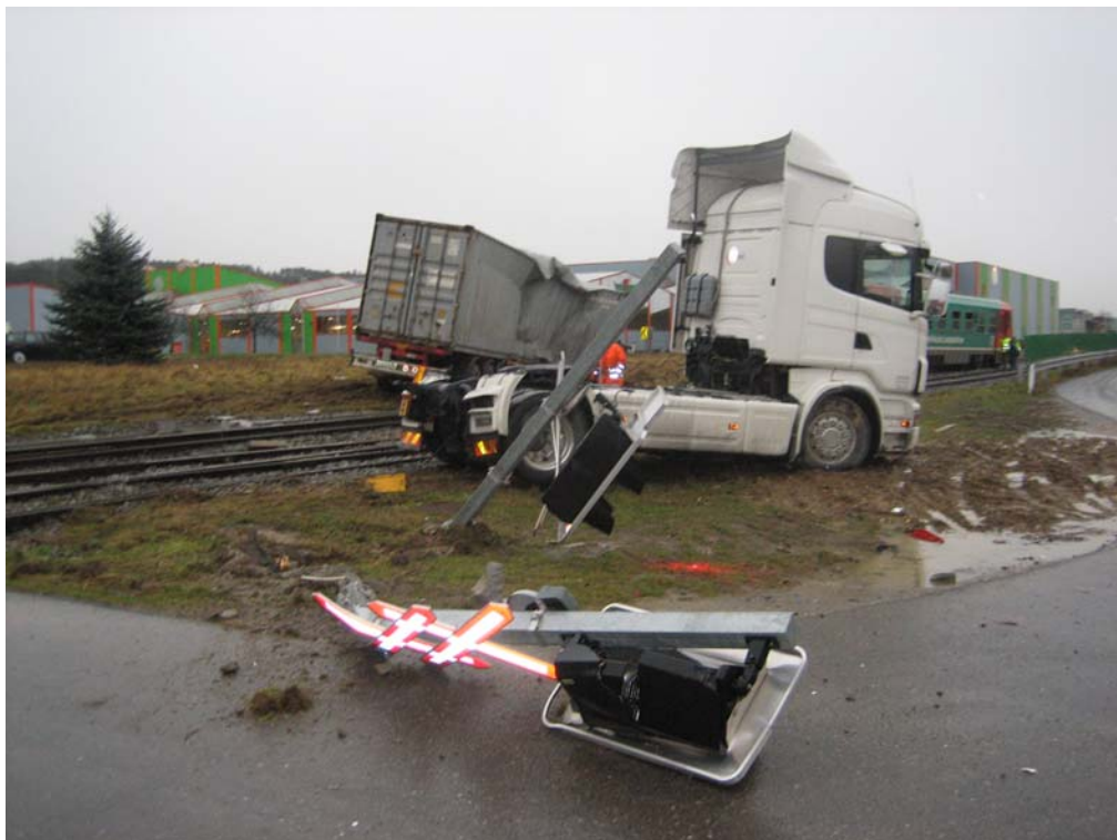
Abbildung 8 Ansicht der zerstörten EKSA und der beteiligten Fahrzeuge
