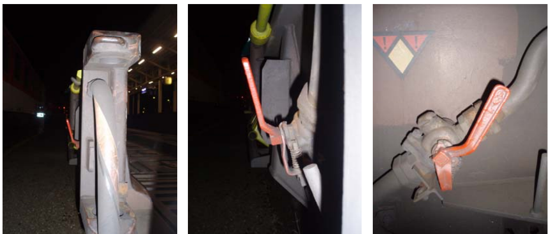
Abbildung 5 Luftabsperrrhahn in „Offen“ Stellung am Wagen 83 81 498 3 885-9 - Quelle ÖBB
