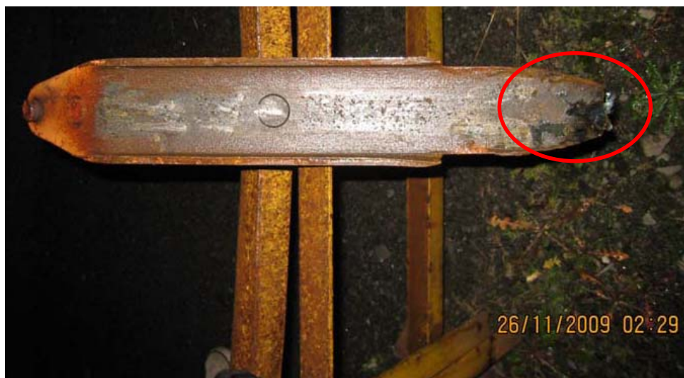
Abbildung 4 Zur Absplitterung zugehöriger Hemmschuh
