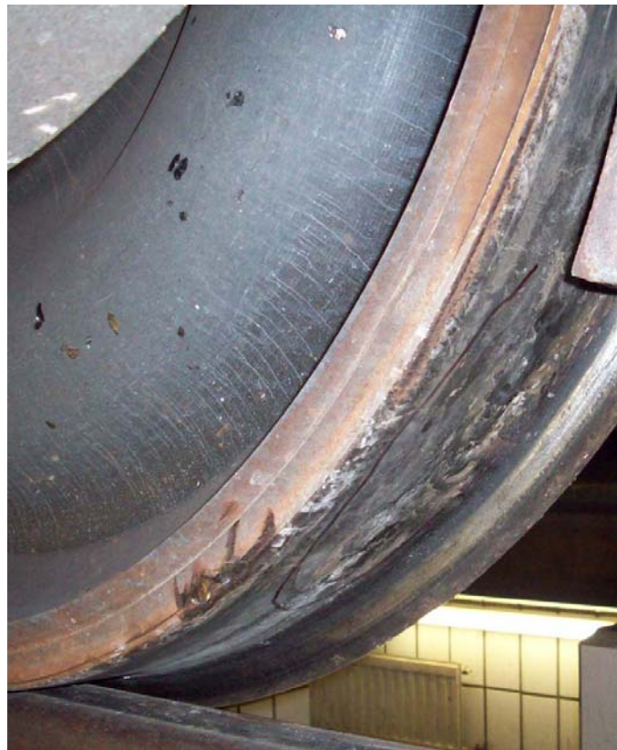
Abbildung 6 Spuren am Radsatz
