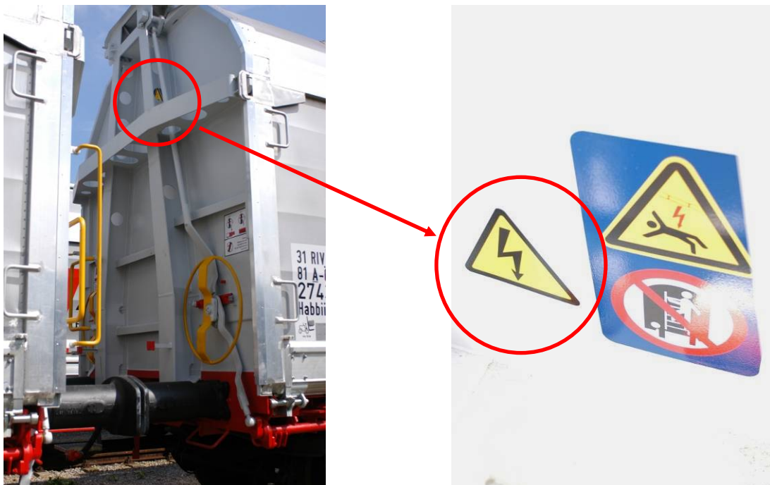
Abbildung 3 Warnhinweise an der Wagenstirnseite
