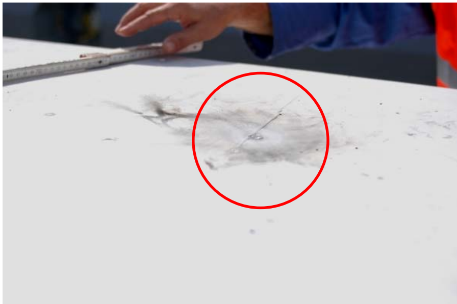
Abbildung 9 Schäden durch Stromüberschlag am Güterwagen
