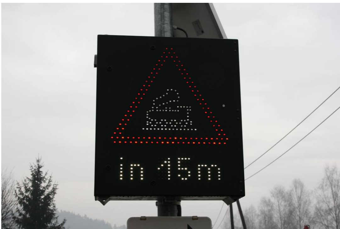
Abbildung 7 Vorhandenes Gefahrenzeichen „Bahnübergang ohne Schranken“ lt. StVO §50/6b
