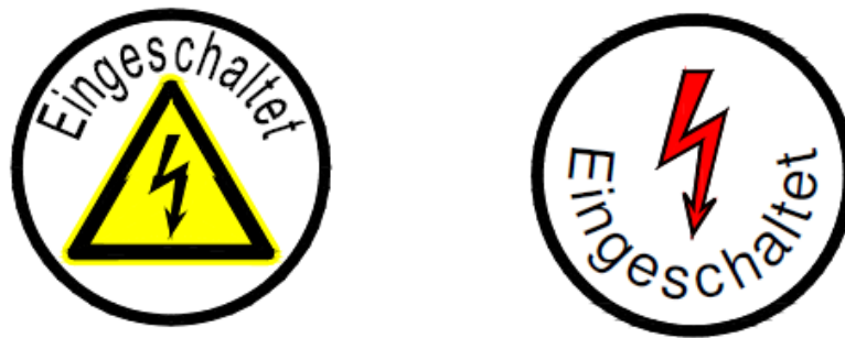
Abbildung 2 Schaltzeiger Stellung „EIN“ (Quelle: ÖBB-Infrastruktur AG)
