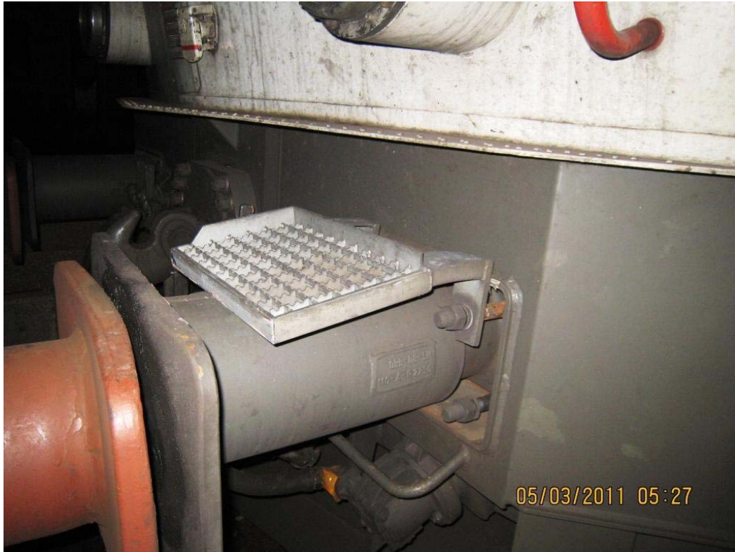
Abbildung 3 Eingedrücktes Stoßverzehrelement des Nachschiebe-Tfz – Quelle IM
