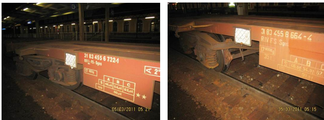
Abbildung 4 Entgleister 19. und entgleister 20. Wagen von Z 41818 – Quelle IM
