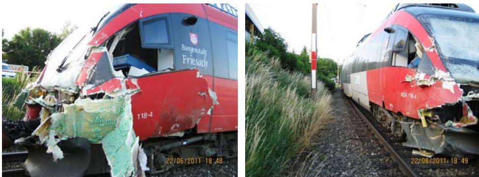
Abbildung 3 Entgleister Tz - Quelle IM
